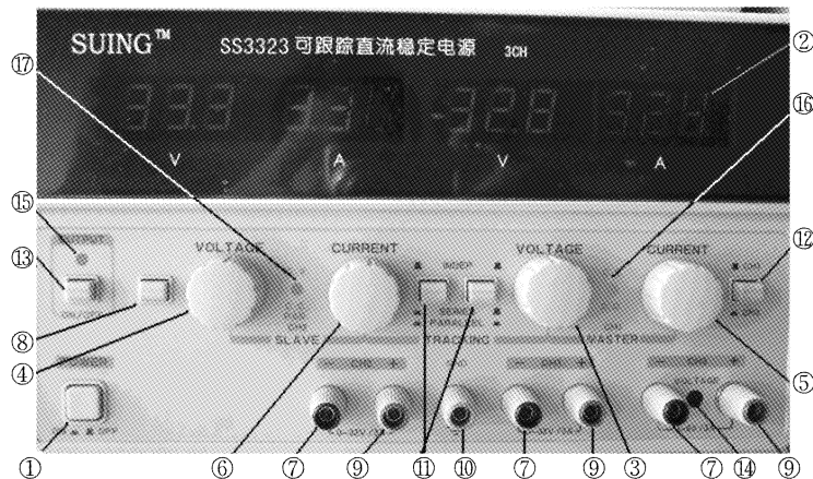
图 2.2 SS3323 型三路可调直流稳压电源面板
