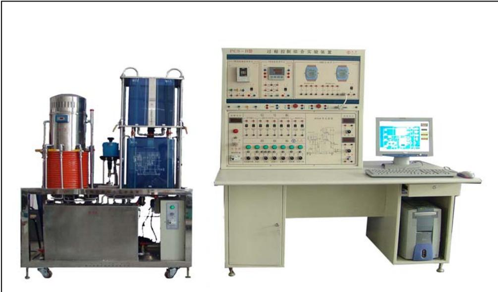
图 4-1 PCS-B 型过程控制实验装置面板图
