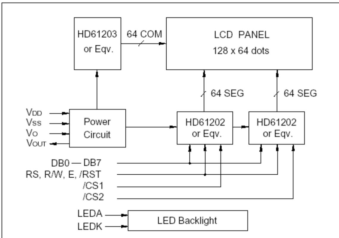
在LG12864 中，两片HD61202 及其兼容控制驱动器的ADC 均接高电平，RST 也接高电平，这样在使用LG2864 时，就不必再考虑这两个引脚的作用，/CS1 跟HD61202(1)的CS1 相连，/CS2 跟HD61202(2)的CS1 相连，因此/CS1、/CS2选通组合信号为/CS1 、/CS2 = 01 选通（1）， /CS1 /CS2 = 10 选通（2）。
