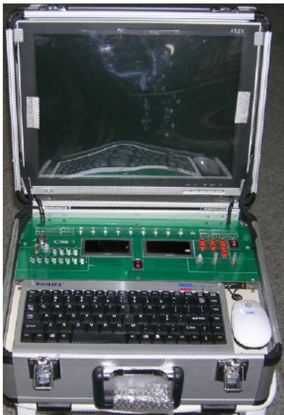
图 3 Ht-log 测井地面系统的内部结构
