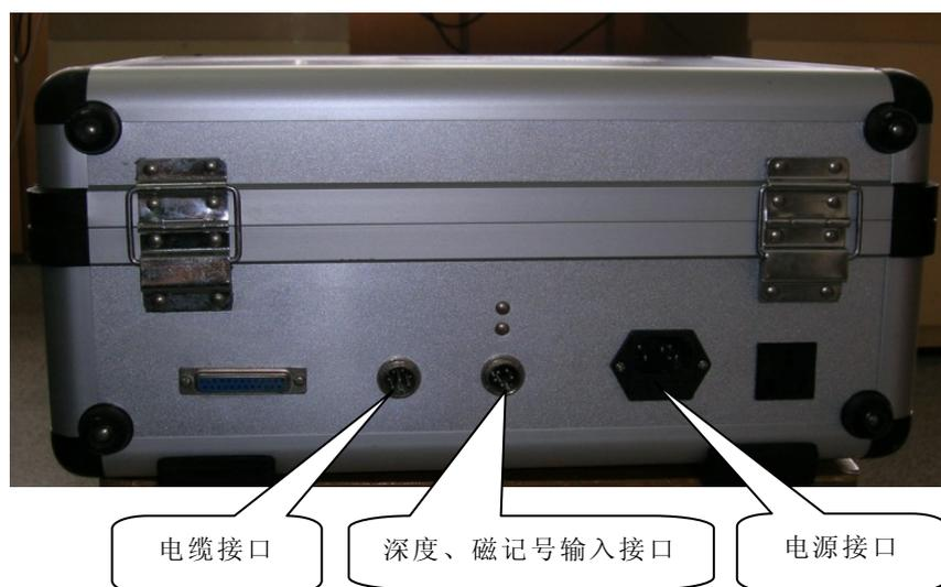
图 8 Ht-log 测井地面系统接口示意图
