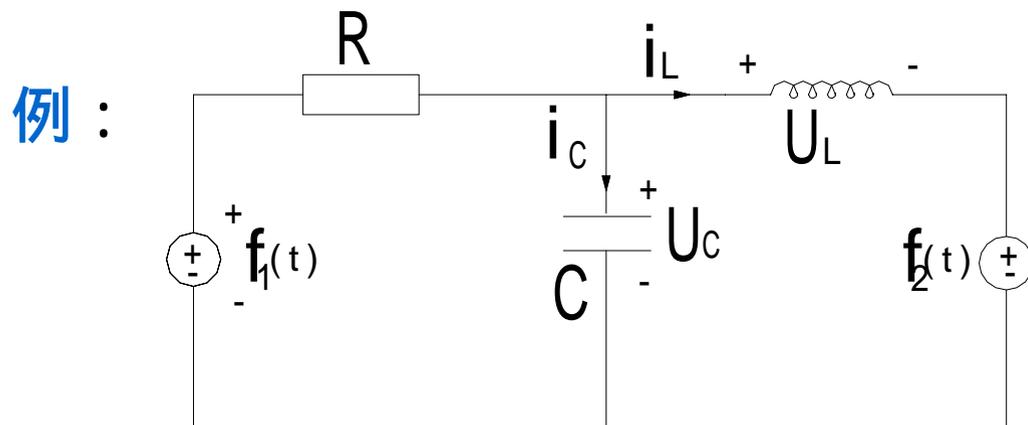
系统输入： $f_1(t), f_2(t)$  系统输出： $y_1(t) = i_c(t)$
