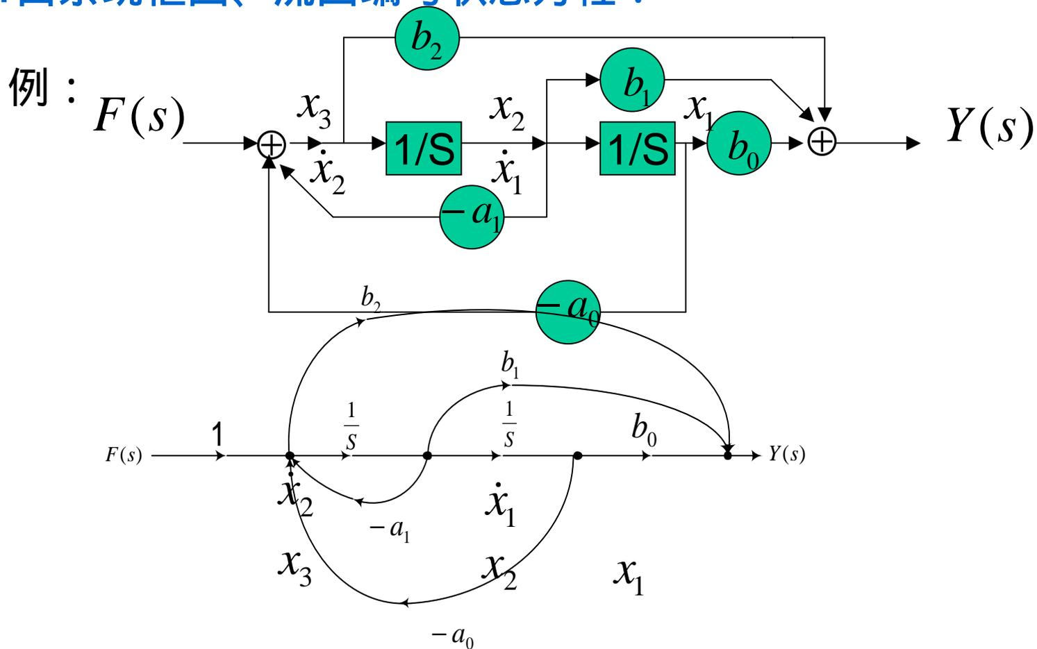
某LTI二阶系统框图及流图如图所示，列写状态方程和输出方程。
