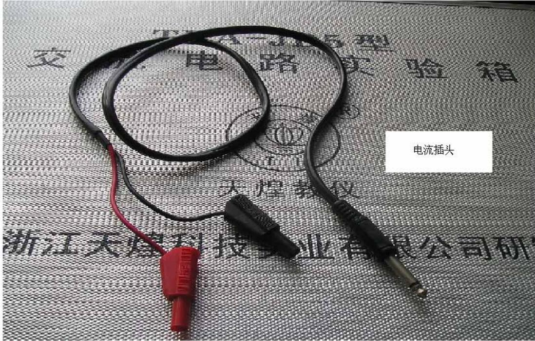
图 4-2 电流插头实物图
