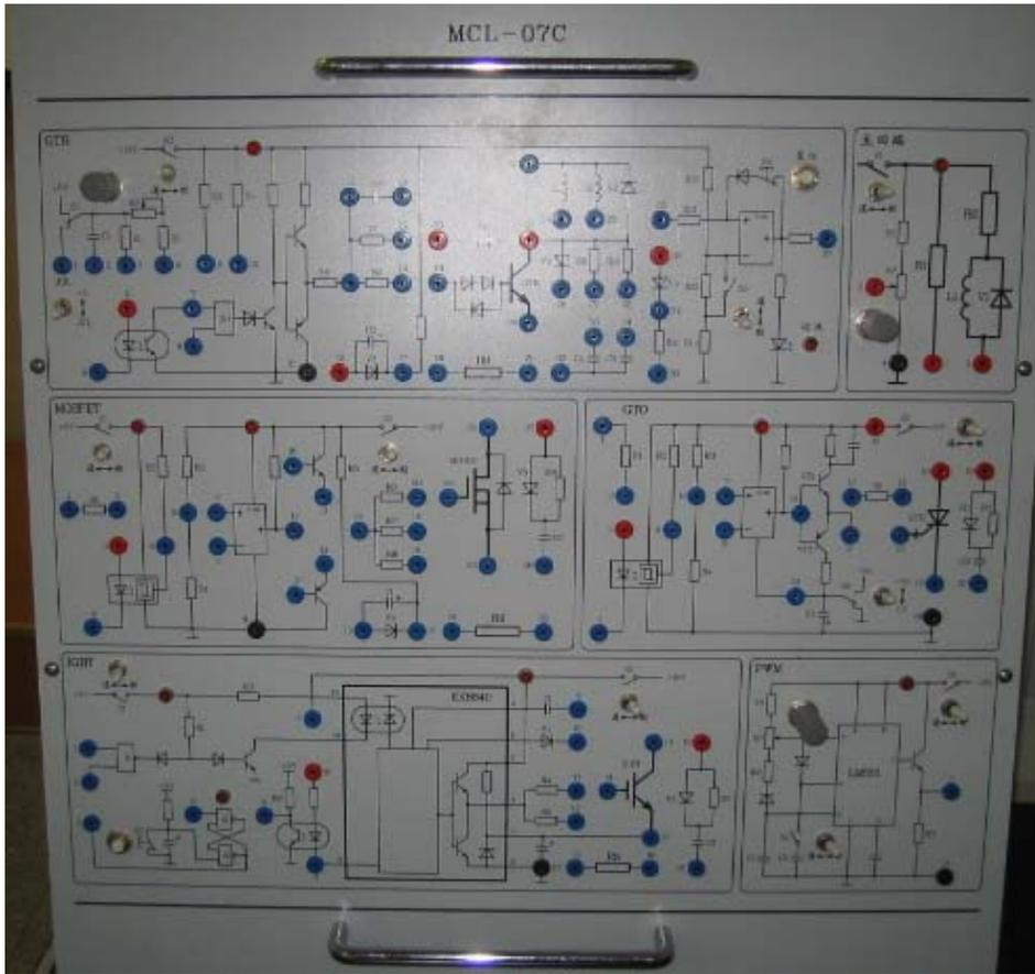
MCL-07 挂箱由 GTR 驱动电路、MOSFET 驱动电路、IGBT 驱动电路、PWM 发生器、主电路等部分组成。
