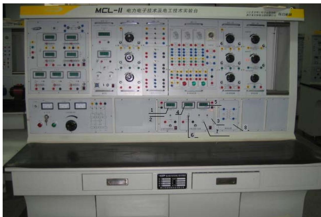
**注意事项：**在整个实验过程中应正确选择仪表合理选择量程；每次接线或改线时要切断电源（7），连接线分两种规格，一种是高压线（带护套）另一种是低压线，其所对应的插孔也不一样，切勿损伤插头，将插头强行插入孔中。实验台专门配有一体的三线电源线，使用时注意选择。无论仪表还是三相电源输出都有过量程或过压过流保护报警功能，当找出故障原因后按下对应的复位
