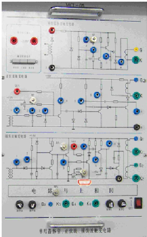
MCL-05 挂箱为触发电路专用挂箱，其中有单晶体管，正弦波，锯齿波同步移相触
