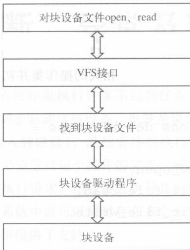
图 5-2 块设备文件的操作流程
