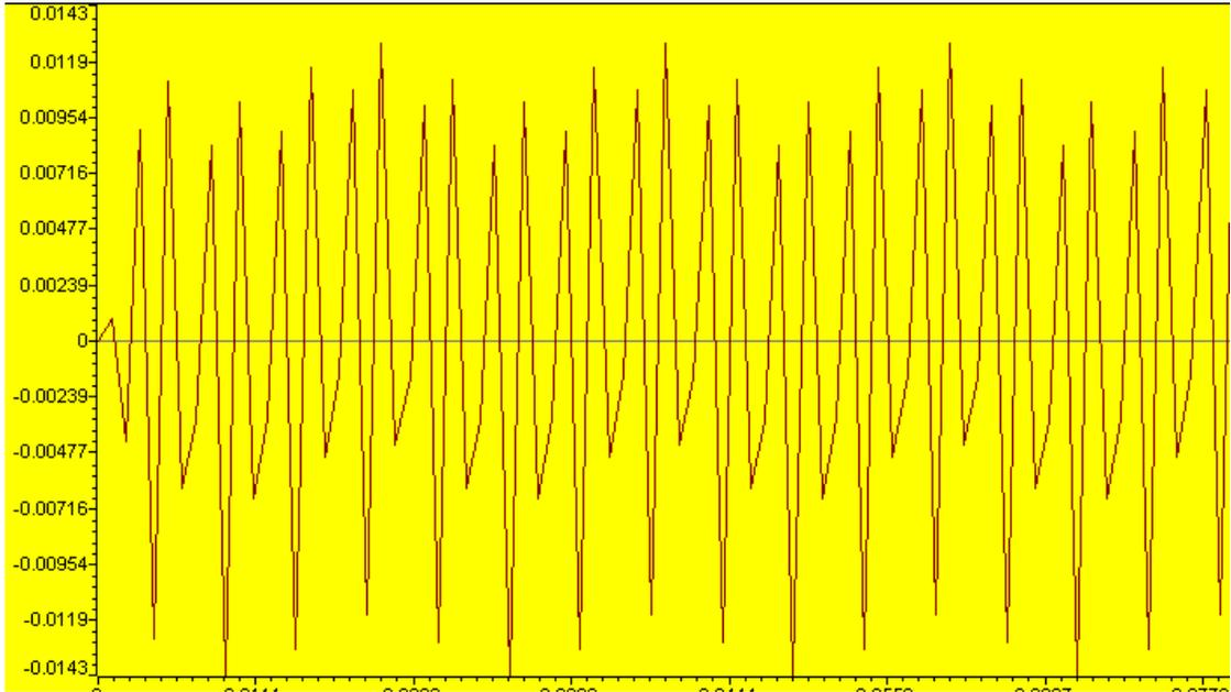
图 3.6 滤波后 CCS 中的数据时域波形
