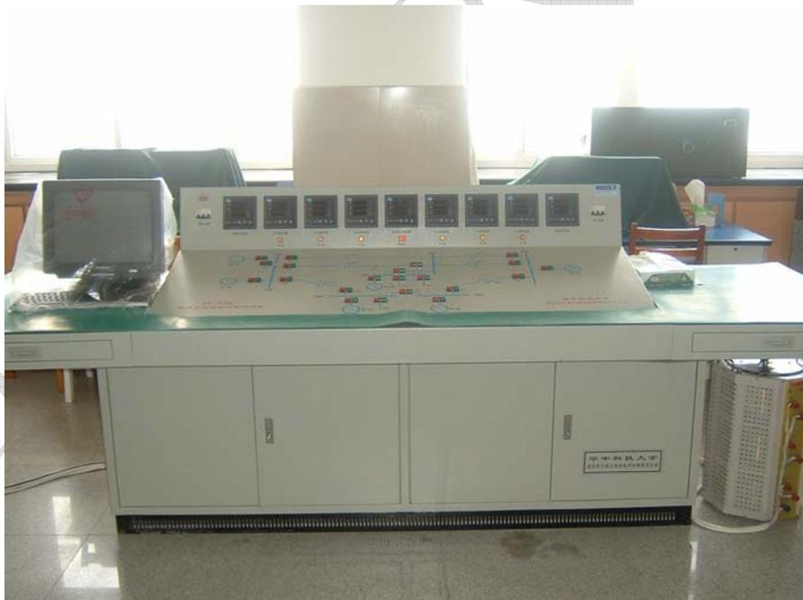
图 1 PS-5G 型电力系统微机监控试验台现场图
