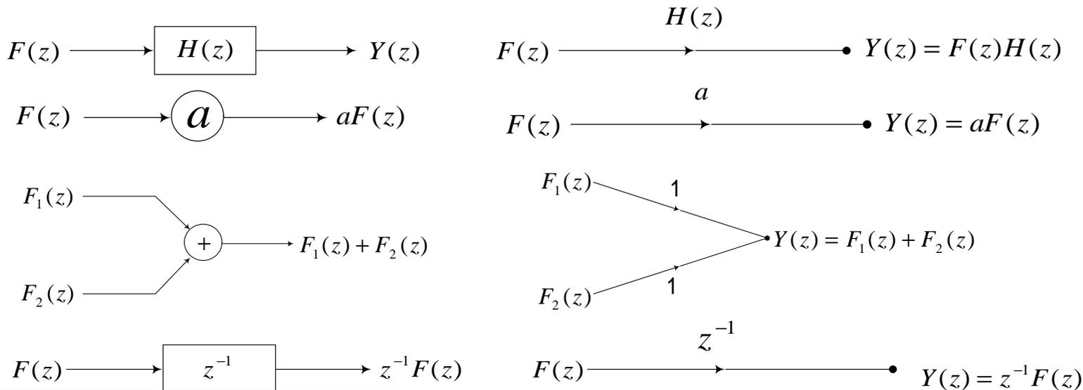
2、信号流图规则：同于连续系统信号流图规则
