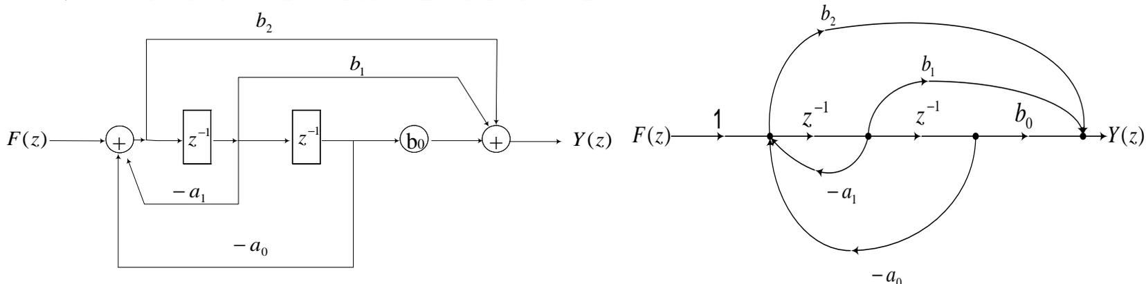
方法：(1) 选加法器输出、单位延迟器输出， $F(z)$ 、 $Y(z)$  为变量用点表示；
