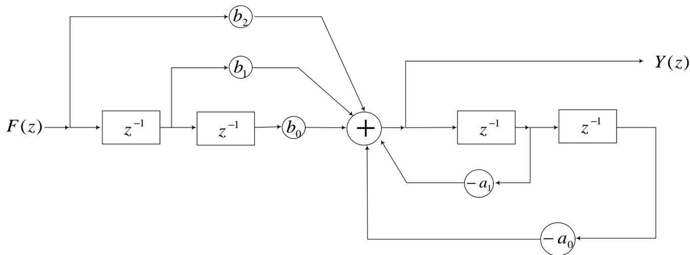
$$Y(z) = -a_1 z^{-1} Y(z) - a_0 z^{-2} Y(z) + b_2 F(z) + b_1 z^{-1} F(z) + b_0 z^{-2} F(z)$$
