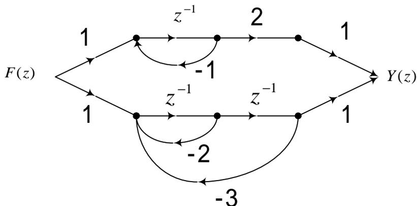
解：(1) 流图的环传输函数  $L_i$  及  $\Delta$ ：
