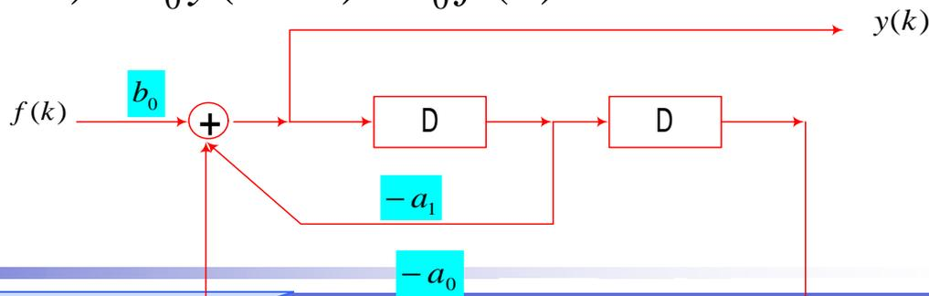
**例2**、已知系统函数  $H(z) = \frac{b_1z + b_0}{z^2 + a_1z + a_0}$  , 求系统框图
