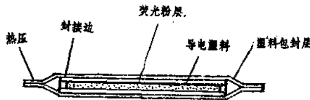
图 4-21 EL 的结构及原理
